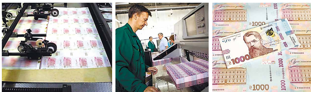
Процес виготовлення паперових купюр*
