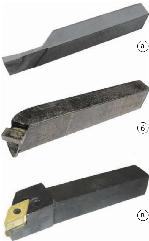
Мал. 14.6. Токарні різці: цілісний (а); з припаяними пластинами (б); зі змінними пластинами (в)
