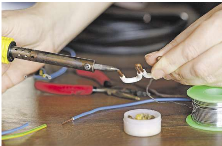
Мал. 4.15. Спаювання дротів за допомогою паяльника
