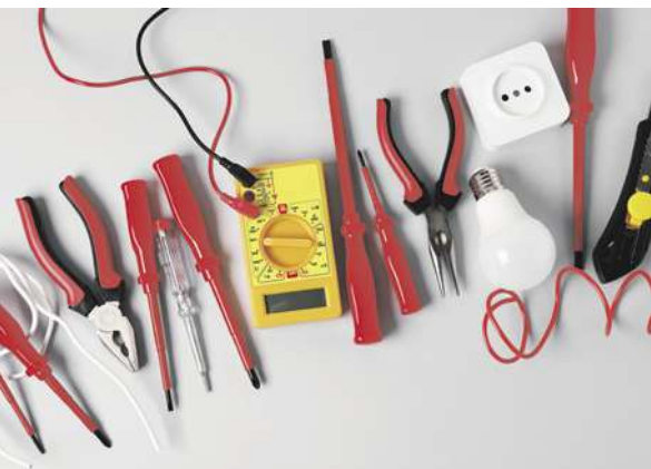
Мал. 4.7. Набір інструментів для стандартних електромонтажних робіт: пасатижі, викрутки, мультиметр, дроти
