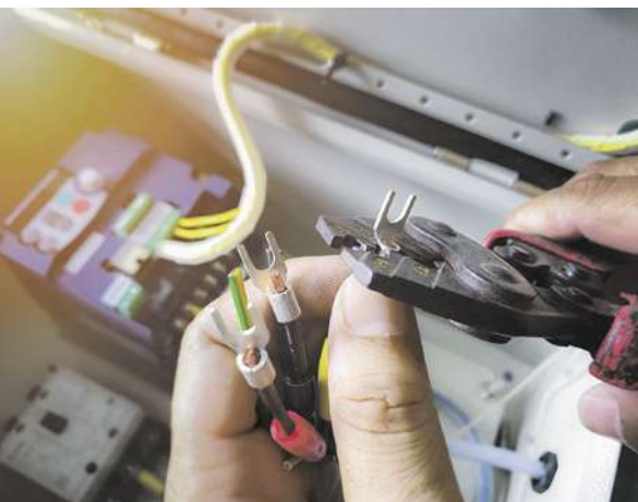
Мал. 4.13. Прес-кліщами опресовують наконечники. А ще ними знімають ізоляцію з дротів
