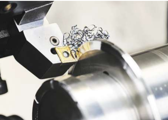
Мал. 14.8. Утворення безперервної стружки свідчить про правильний вибір режиму різання
