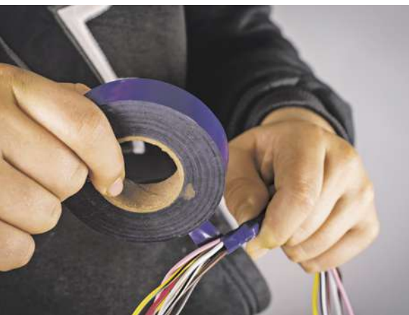
Мал. 4.14. Ізоляційною стрічкою обмотують краї дротів або місце їхнього з'єднання
