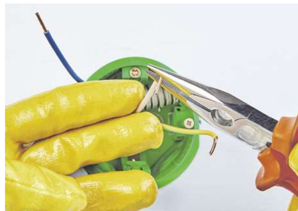
Мал. 4.12. Круглогубцями можна робити кільця на кінцях дротів
