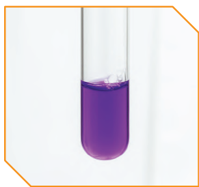
Мал. 77. Кінцевий результат якісної реакції на білки
