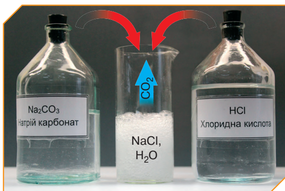
Мал. 28. Реакція йонного обміну між натрій карбонатом і хлоридною кислотою
