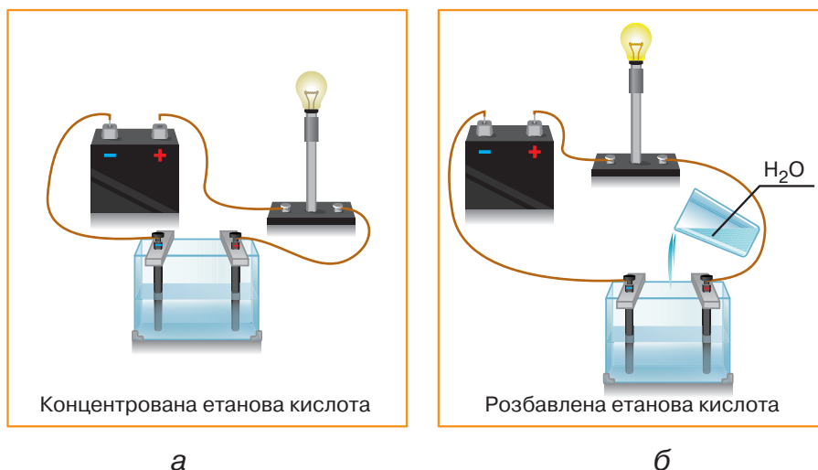
Мал. 23. Вплив концентрації розчину на електролітичну дисоціацію етанової кислоти
