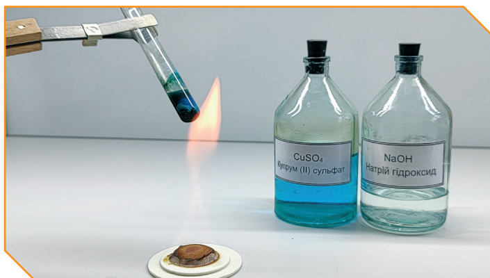
Мал. 98. Проведення термічного розкладу свіжодобутого купрум(II) гідроксиду
