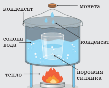
Мал. 8.5. Схема установки для опріснення води
