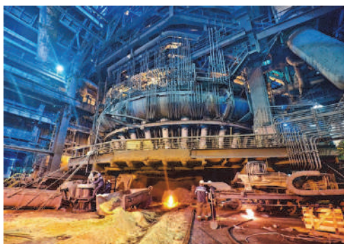
Мал. 109. Найбільша доменна піч в Європі («АрселорМіттал Кривий Ріг»)
