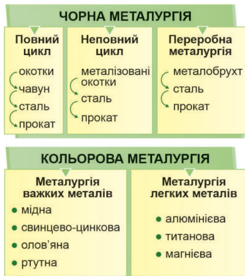
Мал. 104. Структура металургійного виробництва
