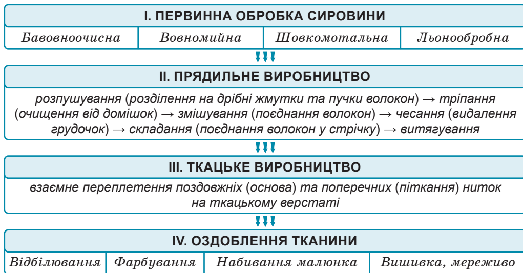
Мал. 145. Стадії виробництва тканини на текстильному комбінаті
