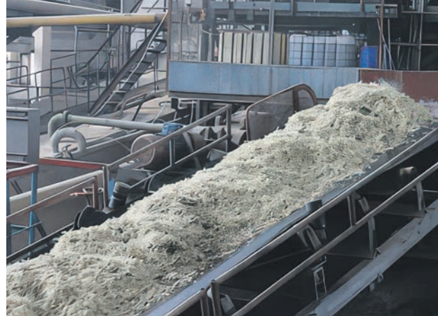
Мал. 2. Конвеєр Крижопільського цукрового заводу (Вінницька область). Для виробництва 1 т цукру потрібно близько 7 т цукрових буряків
