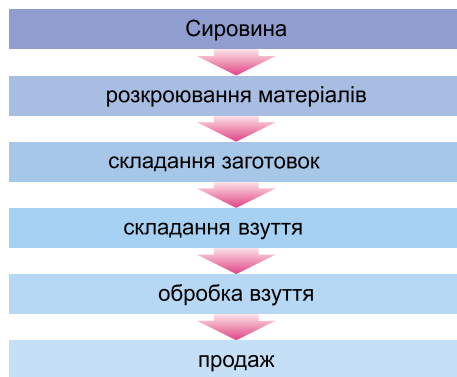
Мал. 124. Технологічні стадії виготовлення взуття
