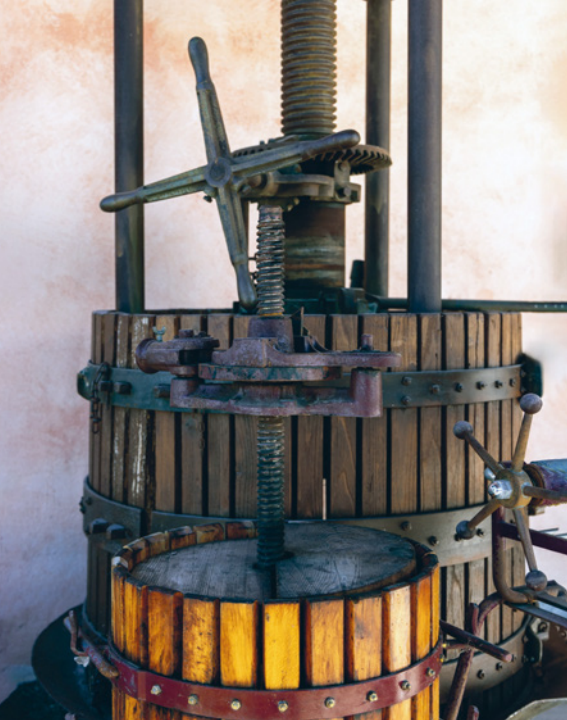
Мал. 4.1. Традиційний гвинтовий прес для отримання олії з плодів оливков шляхом віджиму
