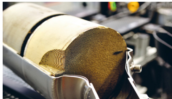
Мал. 7.1. Каталізатор у конвертері (нейтралізаторі) вихлопної системи двигуна внутрішнього згорання
