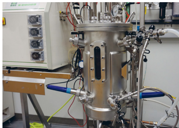
Мал. 33.3. Біореактор для промислового вирощування бактерій
