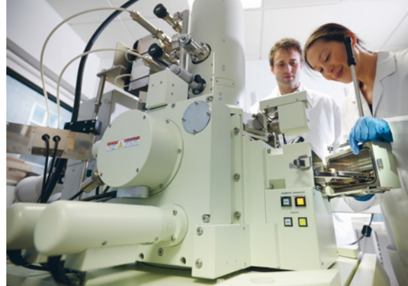
Мал. 11.2. Використання електронного мікроскопа в сучасних лабораторних дослідженнях. На відміну від світлового, цей прилад використовує пучок електронів замість світла, що дає змогу отримати збільшення в сотні тисяч разів і дослідити структуру клітинних органел, вірусів і молекул
