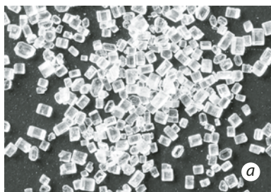
Мал. 9.1. Кристалічний цукор (а) після розплавлення та швидкого охолодження стає аморфною речовиною, з якої легко виготовляти льодяники (б) та карамельки (в)
