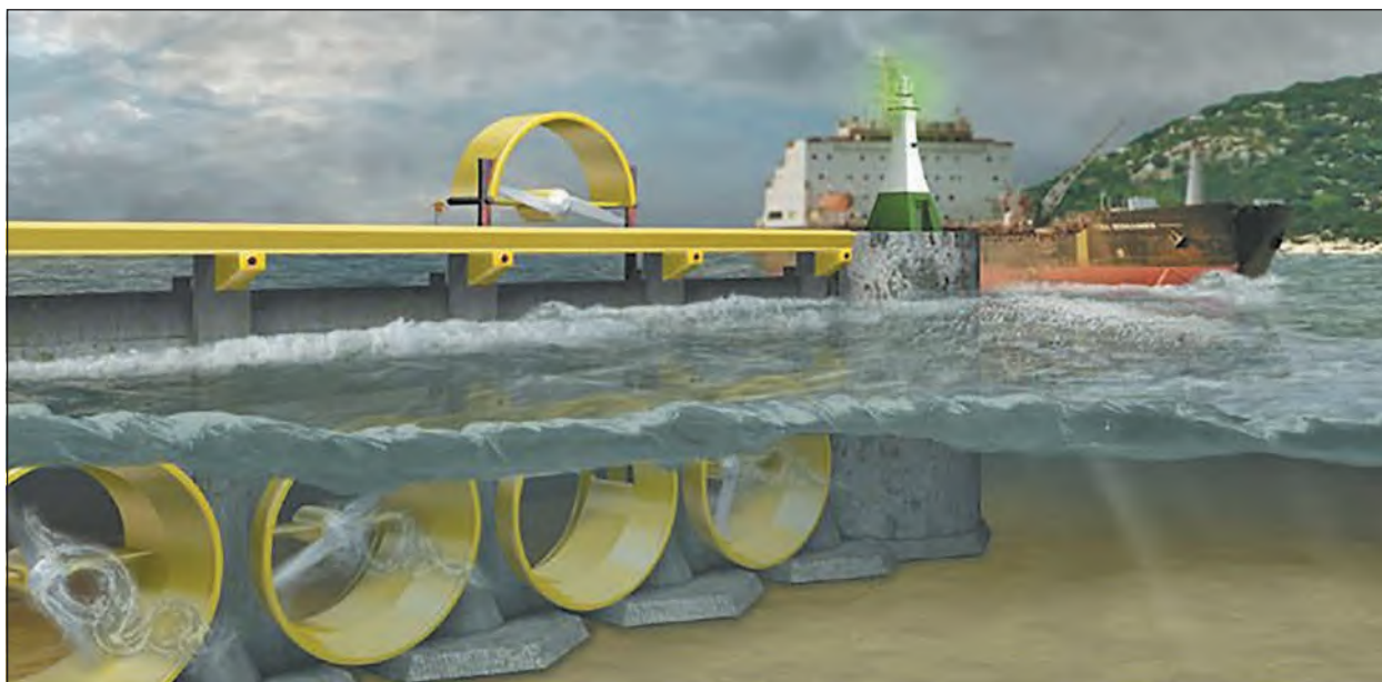
Мал. 3. Принцип роботи припливної електростанції.
