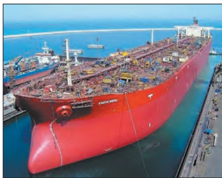
Мал. 5. Японський супертанкер «Кнок Невіс» понад три десятиліття був найбільшим судном світу. Довжина супертанкера становить 458 м, а ширина — 69 м (за розмірами це п'ять футбольних полів). Він здатний перевозити понад півмільйона тонн нафти.
