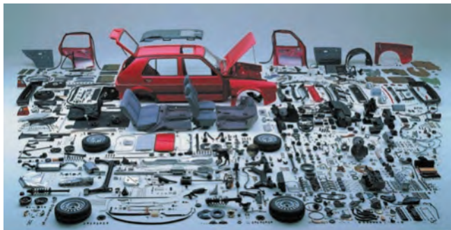
Мал. 2. Деталі автомобіля. Сучасні автомобілі мають не тільки традиційні вузли та агрегати (кузов, шасі, двигун, паливна система тощо), а й складні комп'ютерні системи й елементи автоматизації. Це робить їх зручними й безпечними в експлуатації, але водночас досить складними в обслуговуванні.
