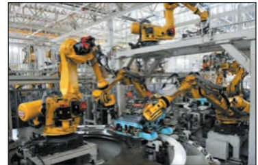
Мал. 2. Промислові роботи в цеху автомобільної компанії «Ніссан» (Японія). Більшість роботів використовують для зварювання, фарбування, установки дрібних деталей, проведення вантажно-розвантажувальних робіт. Найпотужніший робот здатен піднімати вантажі до 1350 кг на висоту до 6 м.
