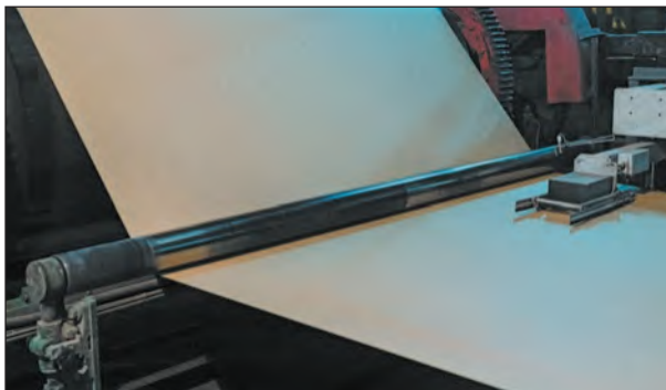
Мал. 5. Зміївська паперова фабрика. У папероробній машині волокниста маса спочатку відливається, утворюючи сиру паперову стрічку, а потім проходить через кілька рядів валиків. Одні віджимають воду, другі обігрівають ізсередини парою та висушують, треті полірують. На останньому етапі готовий папір змотують у рулон.
