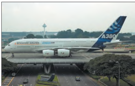
Мал. 4. Двопалубний реактивний пасажирський авіалайнер Аеробус А380 — найбільший серійний літак у світі (висота — 24,08 м, довжина — 72,75 м, розмах крила — 79,75 м). Він перевозить 525 пасажирів у салонах трьох класів або 853 в однокласовому варіанті. Може здійснювати безпосадовні перельоти на відстань понад 15 тис. км.
