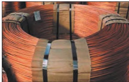
Мал. 2. Мідні дрони. Завдяки високій електропровідності мідь використовується в електротехніці для виготовлення дронів, кабелів, струмопровідних частин електротехнічної апаратури.
