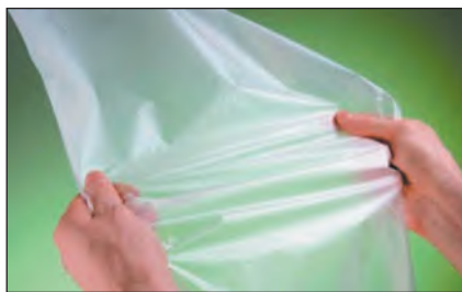
Мал. 6. Поліетилен — досить міцний матеріал. Плівку з нього можна згинати, м'яти, але важко порвати. Поліетилен не проводить електричний струм. Він є стійким до впливу кислот, лугів. Окремі різновиди поліетилену застосовуються у виробництві бронежилетів і навіть броньованих автомобілів.
