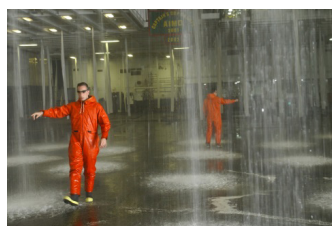
Мал. 14.6. Спринклерні системи пожежогасіння: а) спринклер; б) випробовування системи.
