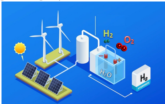
Мал. 19.2. Схема одержання зеленого водню електролізом води
