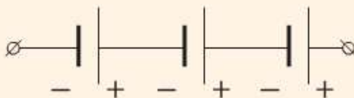
Мал. 136. Послідовне з'єднання джерел струму в батарею
