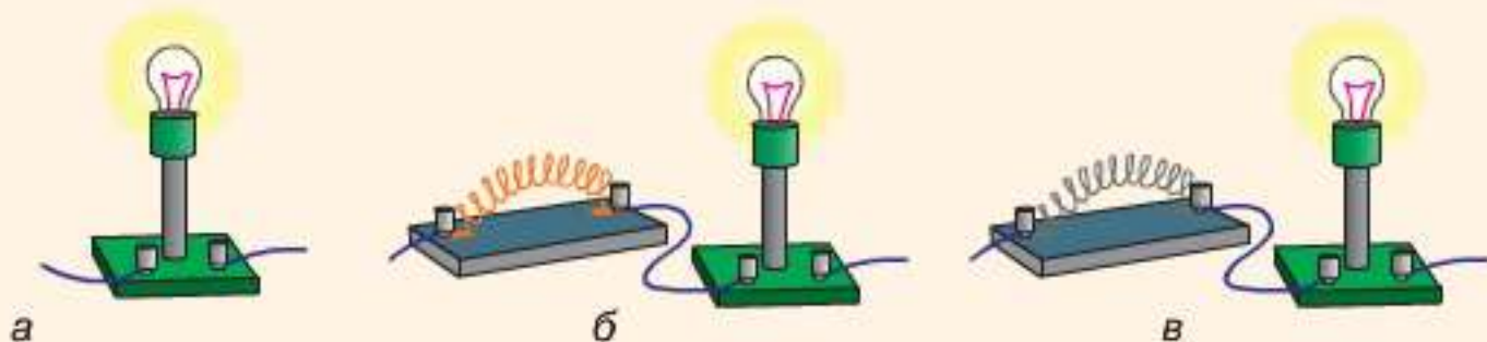
Мал. 121. Послідовне включення металевих пластин: а — лампа; б — лампа та залізна спіраль; в — лампа та ніхромові спіраль
