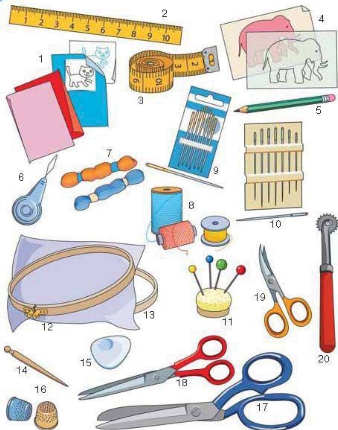
Мал. 25. Інструменти і пристосування для ручних швейних робіт: 1 — копіювальний папір; 2 — лінійка; 3 — сантиметрова стрічка; 4 — калька; 5 — олівець; 6 — нитковтягувач; 7 — нитки для вишивання; 8 — нитки для шиття; 9 — вишивальні голки; 10 — голки для шиття; 11 — гольник з шпильками; 12 — полотно для вишивання; 13 — п'яльці; 14 — кілочок; 15 — крейда; 16 — наперстки; 17 — ножиці для розкроювання тканини; 18 — ножиці для розрізання ниток; 19 — ножиці для обрізання кінців ниток та вирізування; 20 — різець
