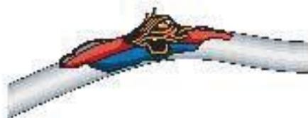
Мал. 116. Пошкодження ізоляції у шнурах живлення
