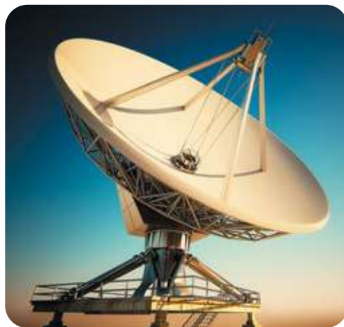
Рис. 13.16. Радіотелескопи містять великі тарілки для збору радіохвиль
