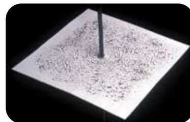
Рис. 10.14. Магнітне поле провідника зі струмом
