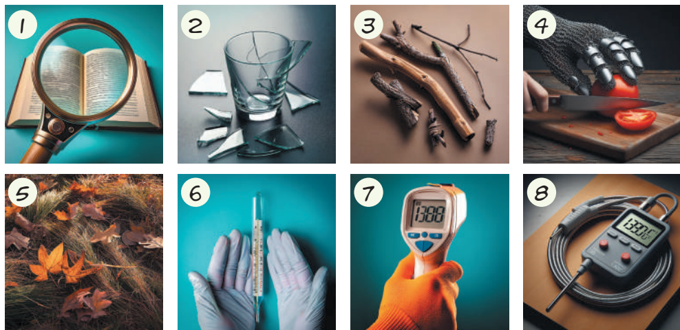
Мал. 7.2. 1 Збільшувальна лінза. 2 Уламки скла. 3 Хмиз, ломачця. 4 Кольчужна рукавичка для запобігання порізам. 5 Сухе листя, підсохла трава. 6 Медичний ртутний термометр. 7 Інфрачервоний безконтактний пірометр (200–2200 °С). 8 Термопара зі щупом (0–1500 °С)
