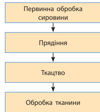
Мал. 2. Стадії текстильного виробництва.
