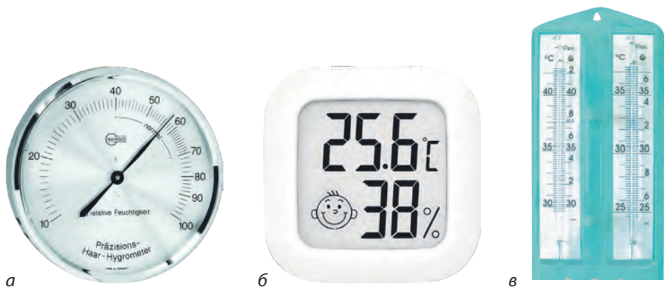
Мал. 6. Прилади для визначення вологості повітря в приміщенні: а) гігрометр механічний; б) гігрометр електронний; в) психрометр.
