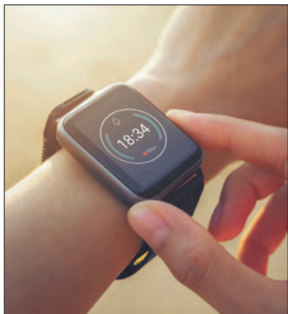
Мал. 4. Смартгодинник (розумний годинник). Крім вимірювання часу, він виконує додаткові функції: аудіоплеєра, термометра, мобільного телефона, GPS-навігатора тощо.
