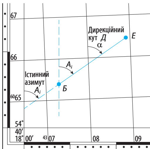
Мал. 1. Вимірювання істинного азимута ( A_i ) та дирекційного кута ( D ) за топографічною картою.
