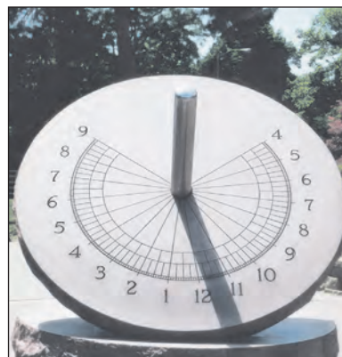
Мал. 1. Сонячний годинник. Гномон (це може бути вертикальна жердина) відкидає тінь від Сонця на циферблат, яка показує час доби вдень.
