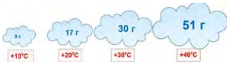
Мал. 43.2. Залежність максимально можливої маси водяної пари в повітрі від температури (для повітря об'ємом 1 м 3 )
