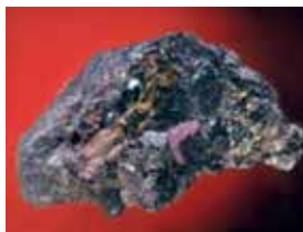
Рис. 45. Магнетиту \text{Fe}_3\text{O}_4 притаманний сильний магнітизм: біля його зразка стрілка компаса відхиляється
