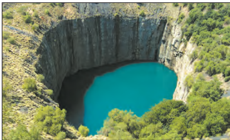
Мал. 1. Кімберлітова трубка «Велика діра» в місті Кімберлі (ПАР), зараз недіючий алмазний рудник. Його площа — 17 га, діаметр — 1,6 км. Це найбільший кар'єр, розроблений без застосування техніки.
