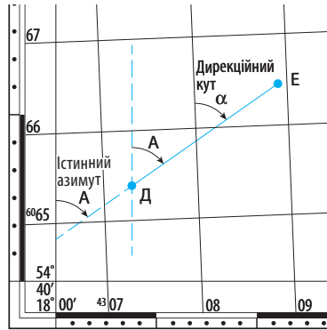
Мал. 2. Вимірювання істинного азимута та дирекційного кута за топографічною картою.
