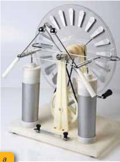
Мал. 129. Інші види джерел струму: а — електрофорна машина, б — термоелемент, в — фотоелемент
