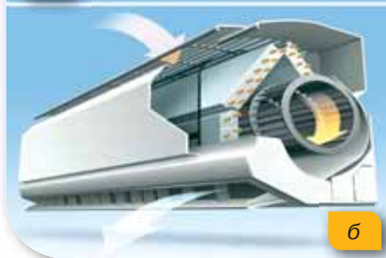
Мал. 74. Кондиціонер: а — зовнішній блок; б — внутрішній блок
