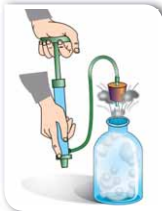
Мал. 26. Дослід зі зменшення внутрішньої енергії повітря завдяки виконанню ним роботи
