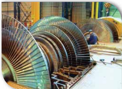
Мал. 69. Потужна промислова багатоступінчата турбіна виробництва «Турбоатом»
