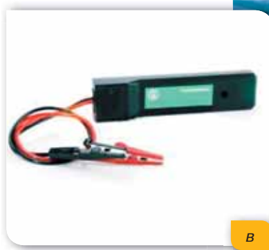
Мал. 123. Гальванометри: а — демонстраційний; б — лабораторний; в — цифровий
