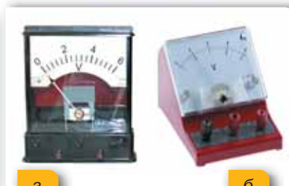
Мал. 148. Вольтметр: а — демонстраційний; б — лабораторний
