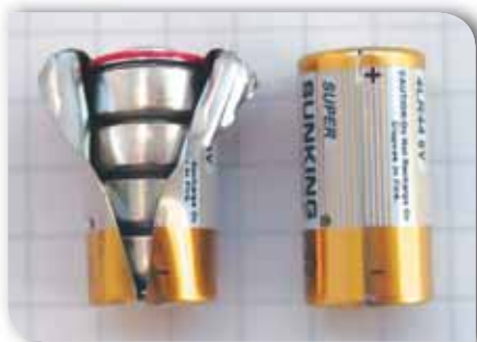
Мал. 128. Батареї: а — акумуляторна; б — гальванічних елементів
