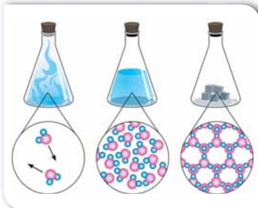
Мал. 10. Склад молекули води однаковий у всіх її агрегатних станах (водяна пара, вода, лід)
