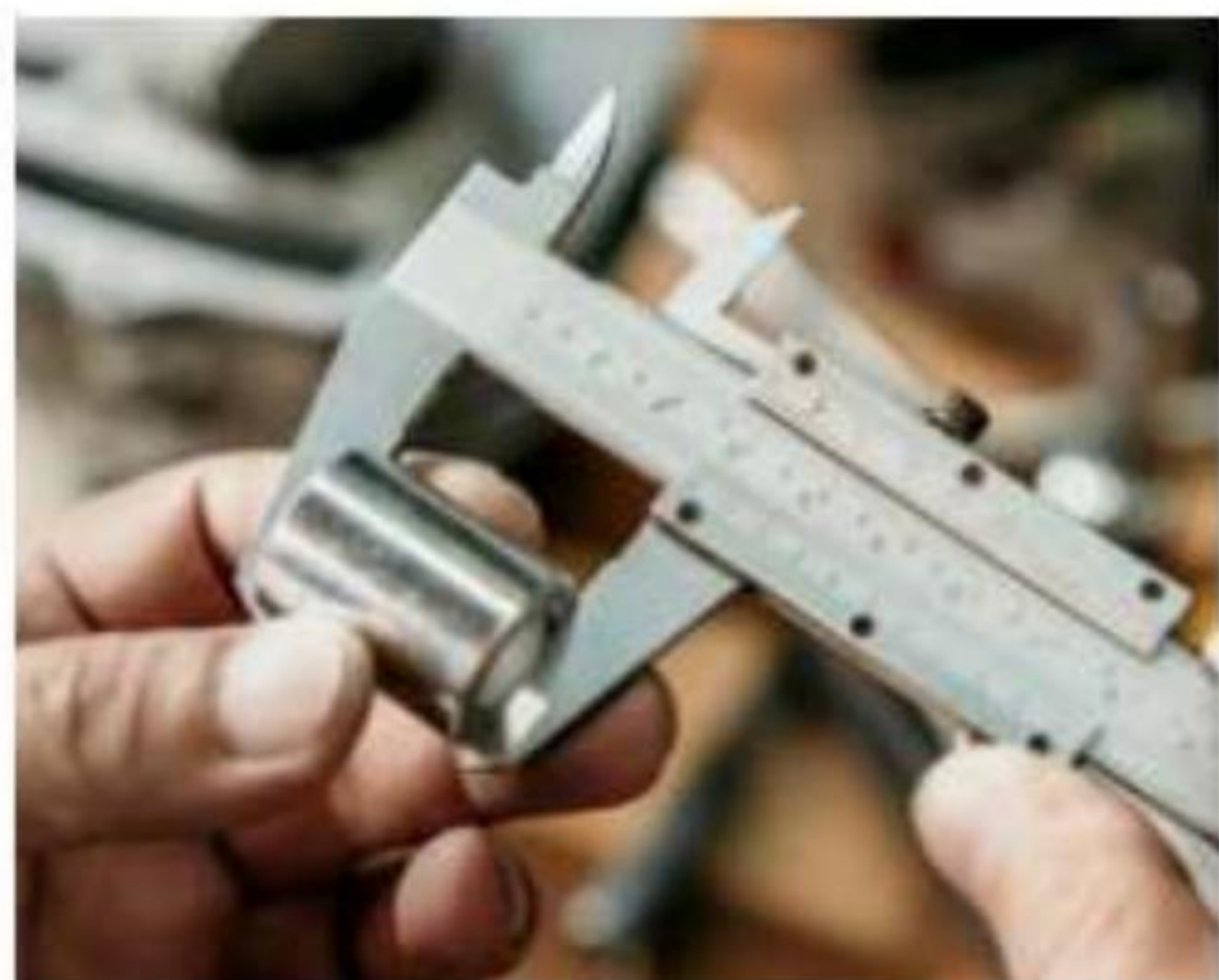
Мал. 133. Вимірювання деталей штангенциркулем
