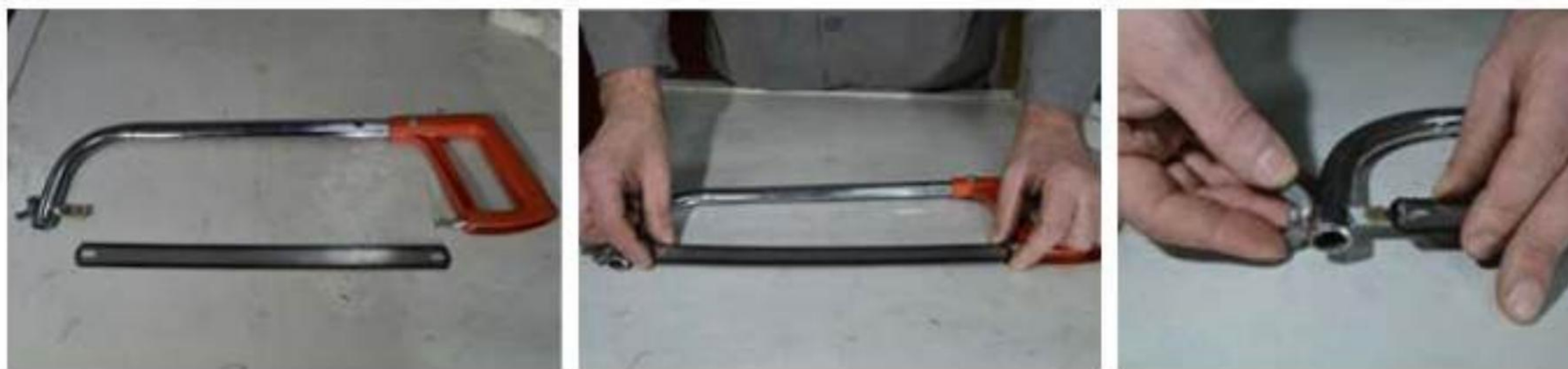
Мал. 129. Встановлення полотна слюсарної ножівки
