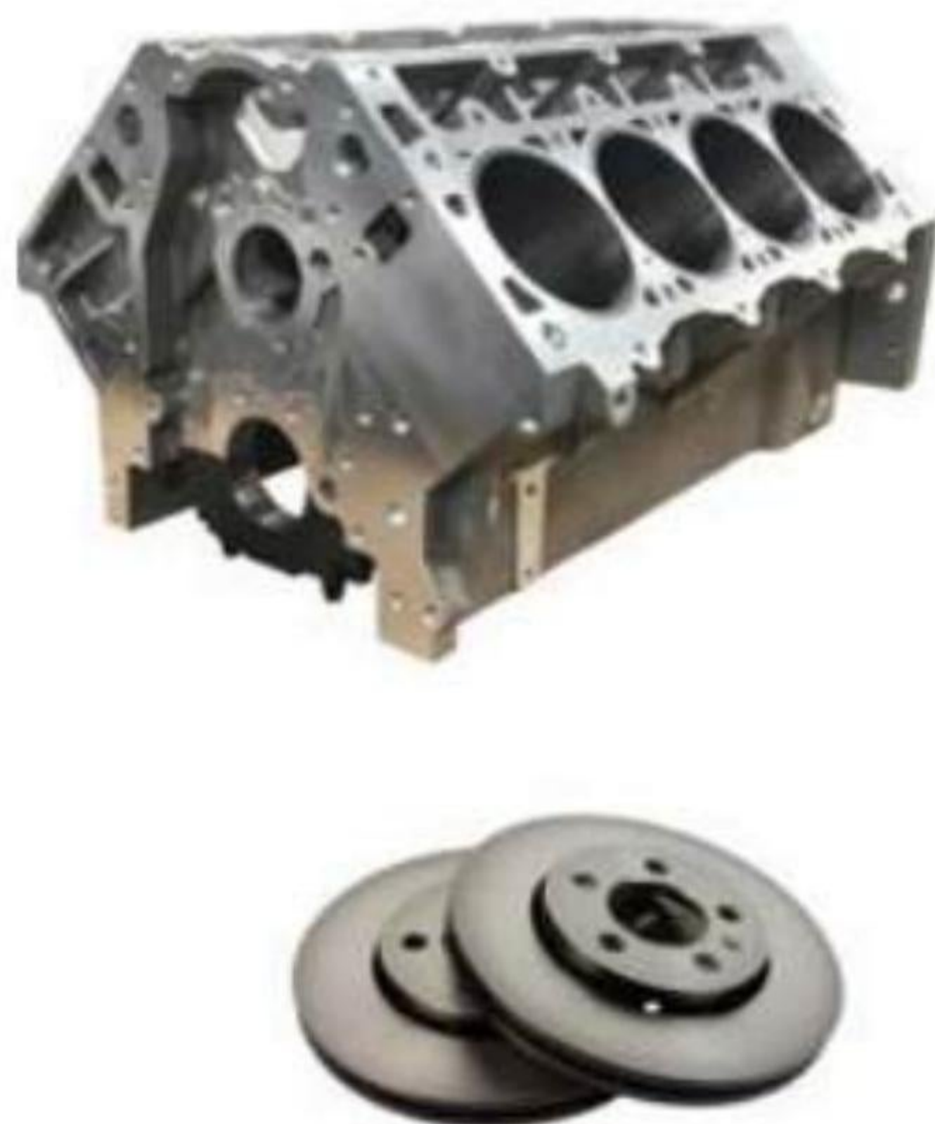
Мал. 104. Деталі автомобіля, виготовлені з чавуну
