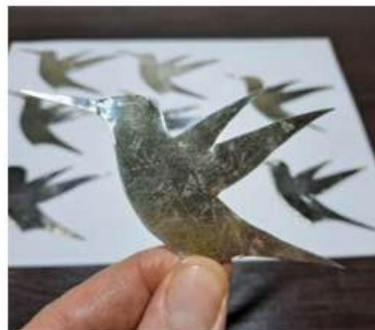
Мал. 128. Деталі, вирізані слюсарними ножицями
