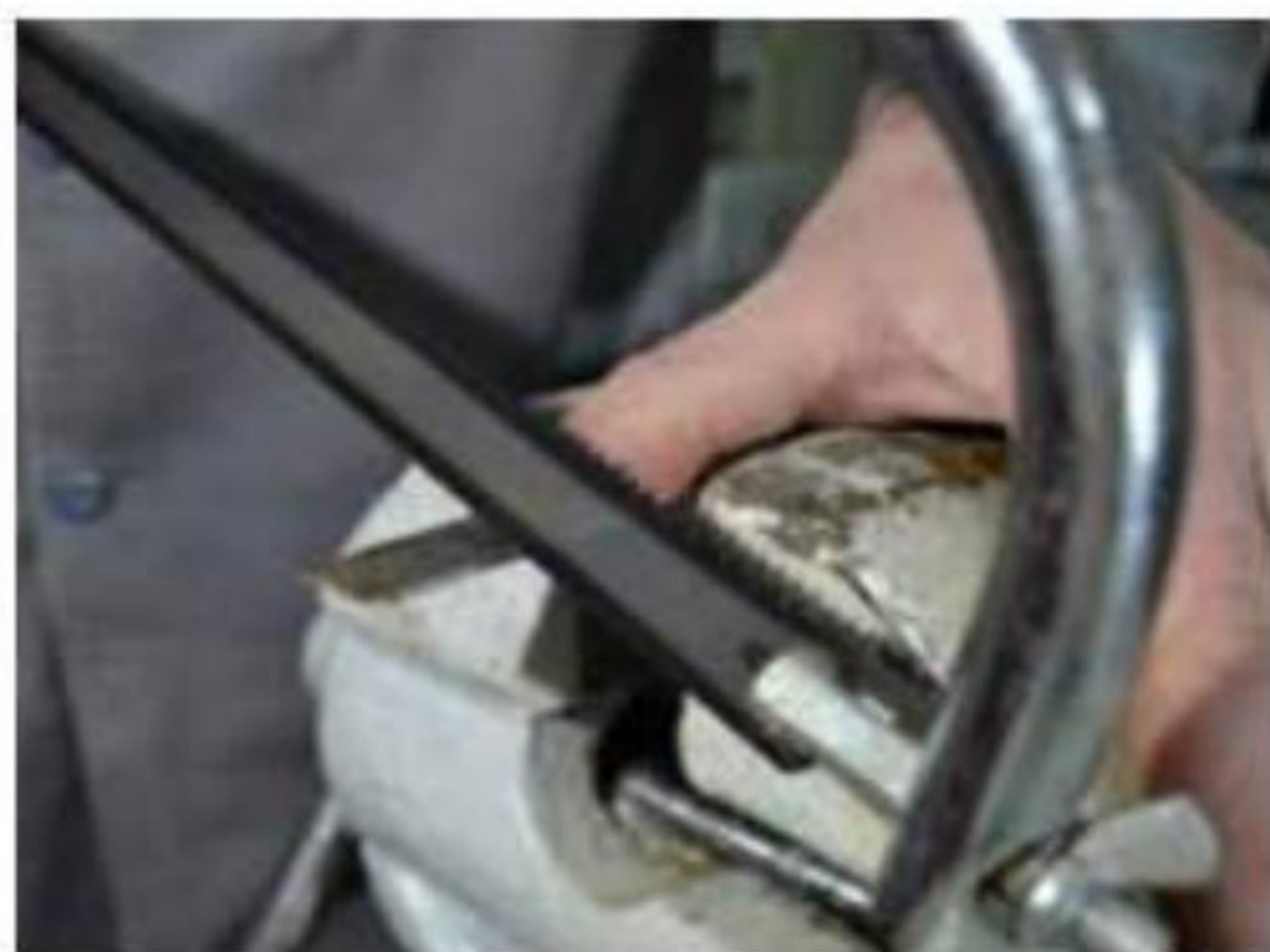
Мал. 131. Різання листового металу слюсарною ножівкою
