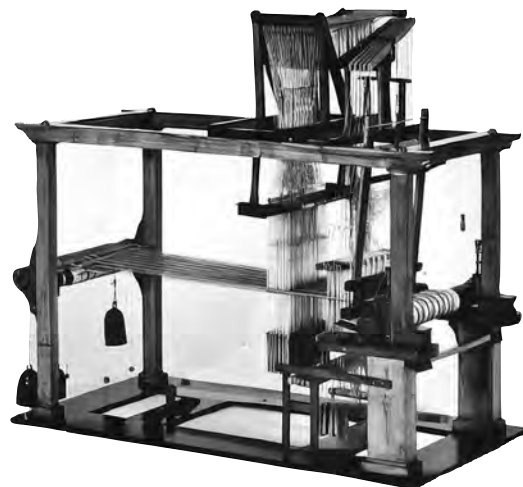
Ткацький верстат, удосконалений К. Дангоном у 1620 р. для виробництва тканин зі складними візерунками.
