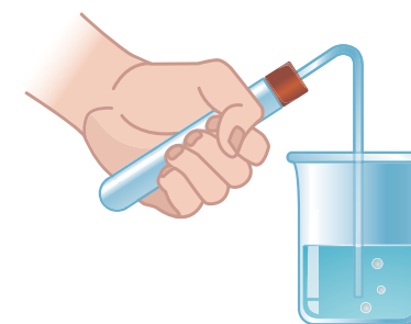
Мал. 20. Перевірка на герметичність приладу для добування газів
