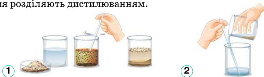
Мал. 12.2. 1. Відстоювання. Суспензія ґрунту із часом розшаровується. 2. Декантування. Воду обережно зливають, осад залишається
