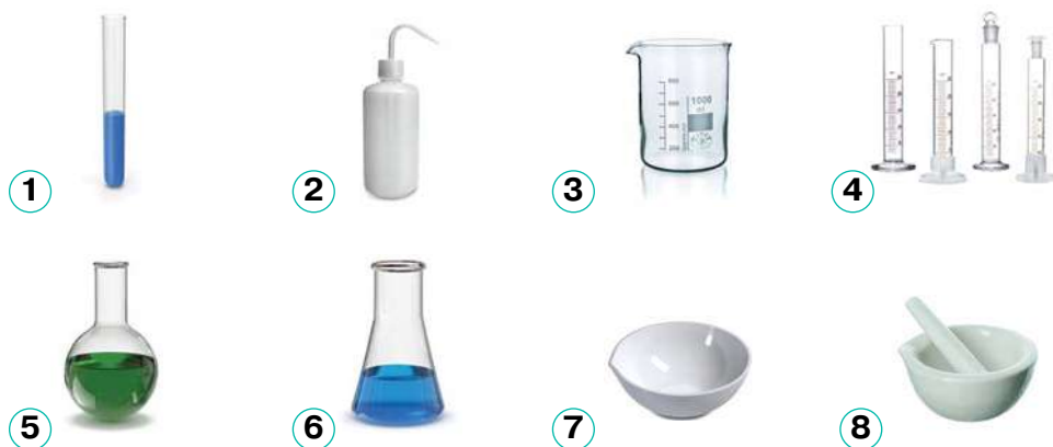
Мал. 2.2. Лабораторний посуд. 1. Пробірка. 2. Промивалка. 3. Хімічний стакан. 4. Мірні циліндри. 5. Круглодонна колба. 6. Конусоподібна колба. 7. Чашка для випарювання. 8. Ступка з товкачиком
