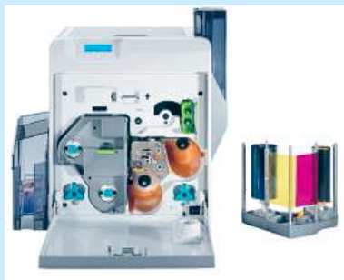
Мал. 3.37. Сублімаційний принтер і набір кольорових плівок до нього
