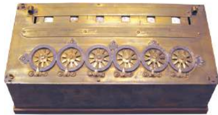
Мал. 3.54. Обчислювальний пристрій «Паскаліна»
