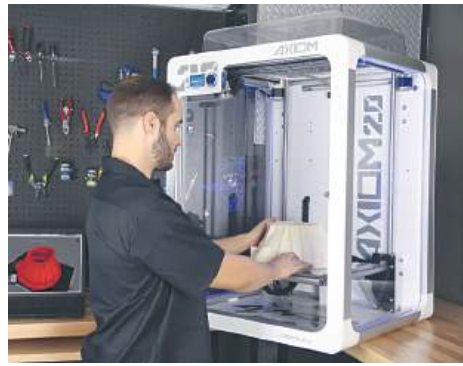
Мал. 3.41. Створення протеза грудної клітки у 3D-принтері
