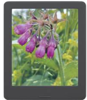
Мал. 3.33. Електронна книга на основі електронного чорнила
