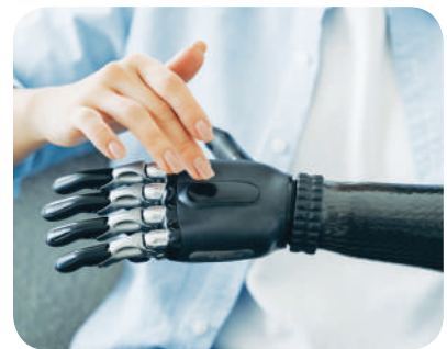
Мал. 2.4. Біонічний протез українського виробництва
