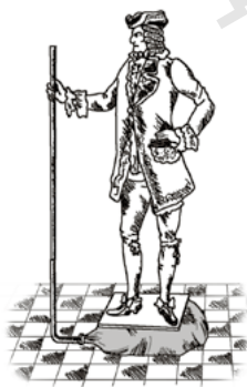
Рис. 30.1. Сила тиску води в шкіряній подушці є достатньою, щоб утримувати дорослу людину
