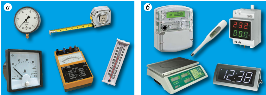
Рис. 3.7. Вимірювальні прилади: а — зі шкалою; б — електронні цифрові
