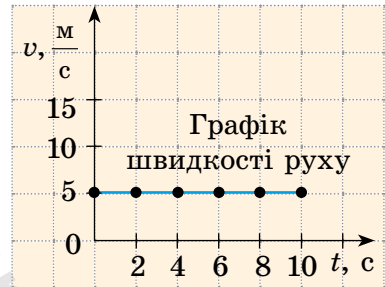
Рис. 10.6. Графік швидкості руху велосипедиста, що рухається рівномірно — з незмінною швидкістю v=5 м/с. Час спостереження t=10 с
